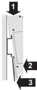
1. Hängen Sie das Zusatzgerät mit der oberen Rasterführung auf der oberen Kante der Hutschiene ein.
