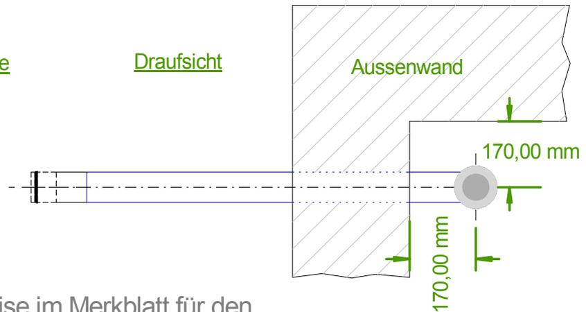
Die rückseitigen Hinweise im Merkblatt für den Einbau der Schutzrohrreinrichtung sind zu beachten und einzuhalten.
